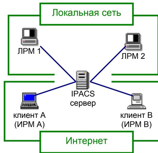
Рис. 2 Вынесение PACS в Интернет.
